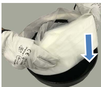
4. Vložte nový prachový pytel vnitřní stranou nahoru.
