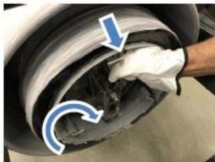
2. Vytáhněte a otočte upevňovací šrouby na držáku prachového pytle, aby se uvolnily.
