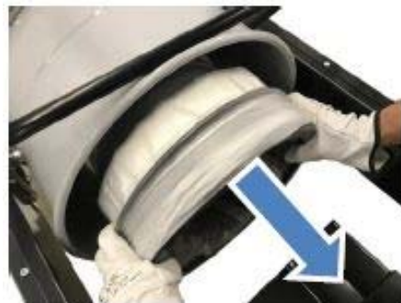
3. Vyměňte držák se zbývajícím prachovým pytlem.
