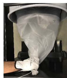
10. Ziehe an dem Dustbag und platziere den Kabelbinder am Ende, um einen neuen Beutel zu erstellen. Verwenden Sie bei Bedarf zwei Kabelbinder.
