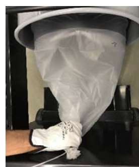
10. Vytáhněte prachový pytel a umístěte pásky na konec, aby vznikl nový pytel. V případě potřeby použijte dva kabelové vazače.
