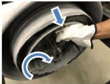
2. Die Haltebolzen des Dustbag-Halters ziehen und drehen, um sie zu lösen.
