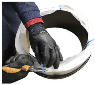
5. Schneiden und entfernen Sie die Verschlussbänder.
