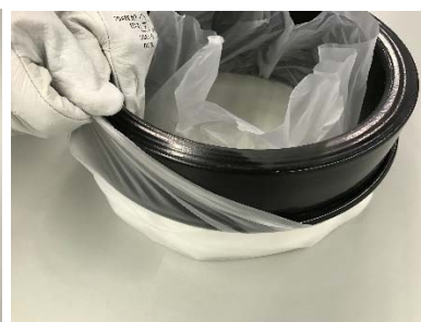
7. Vytáhněte vnější část prachového pytle a vytvořte nový pytel.
