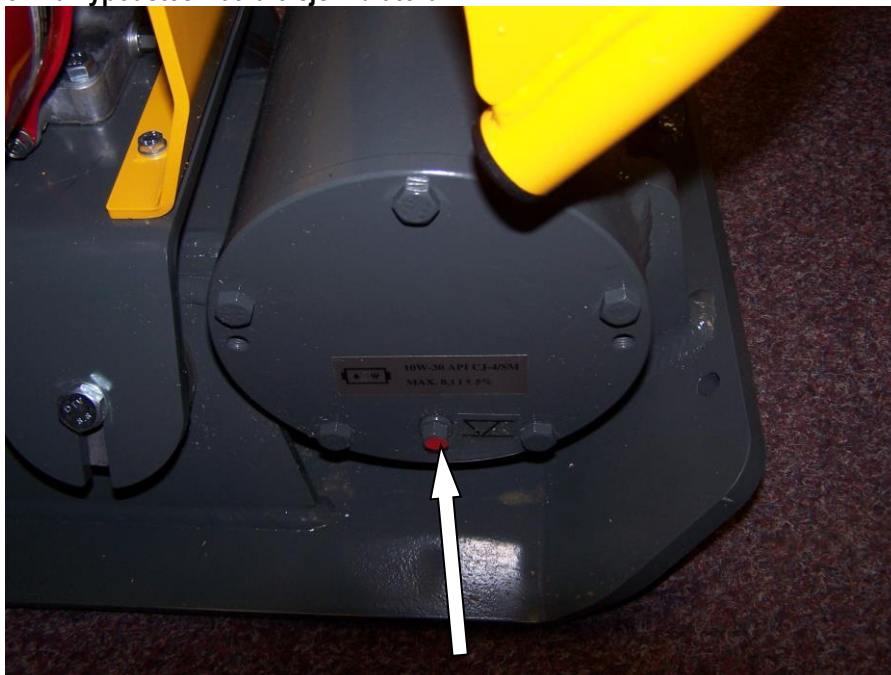
Obr. Plnění, kontrolní a vypouštěcí zátka oleje vibrátoru
