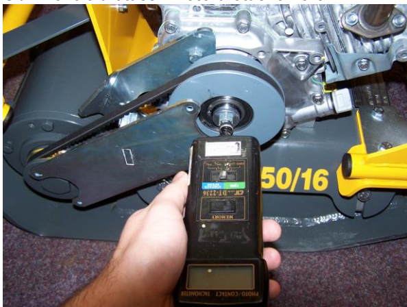
Obr. Kontrola otáček motoru otáčkoměrem
